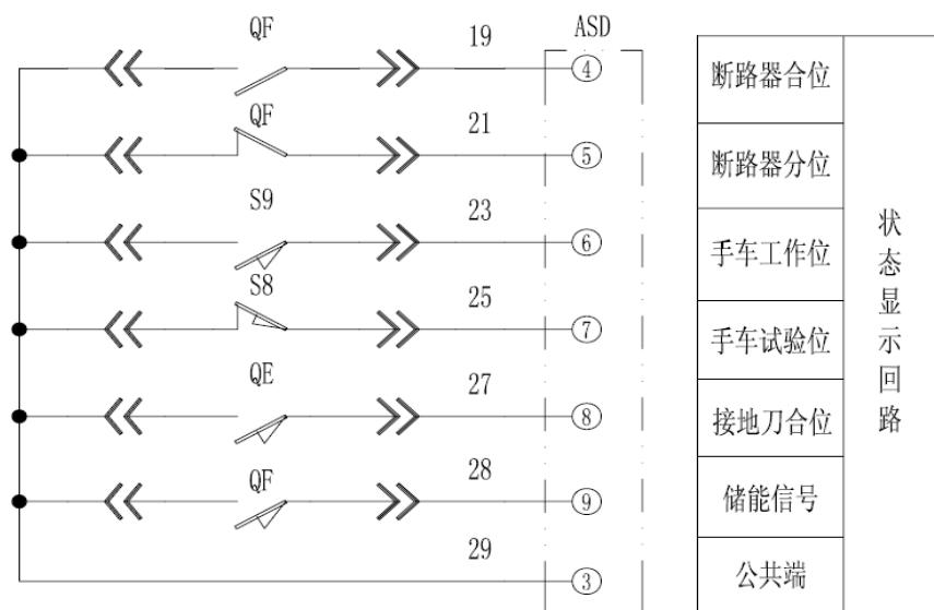
图 1.15 ASD 开关量输入回路典型接线图
