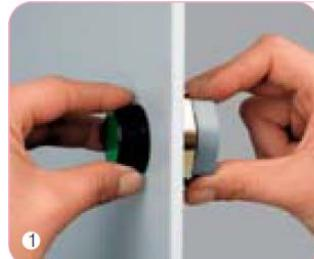
将操作头部由面板前方插入安装孔，于面板后旋入中座，然后均匀拧紧两端紧定螺钉（切不可用力过猛，最大扭力25N·cm），如面板为塑料等其他非金属材料，可在面板后垫上一块安装板（见附件F5）后再安装，如安装孔的直径为25mm时，可在面板后垫上一块Ø25的安装板（见附件F6）后再安装。
