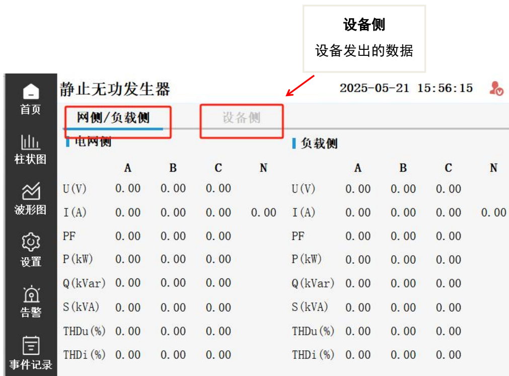
图6-2-2 电网侧/负载侧/设备侧
