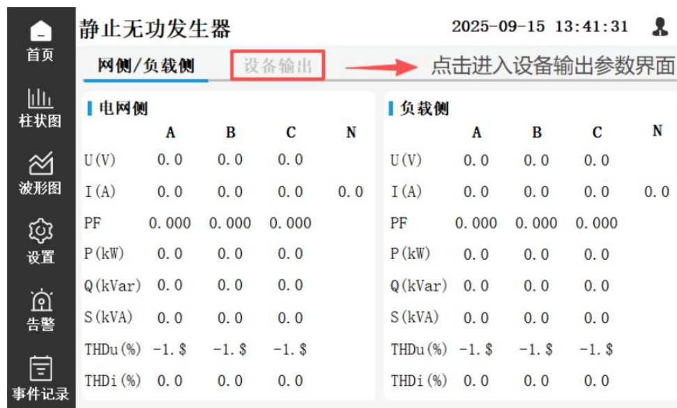
图 6-2 电网侧/负载侧/设备侧
